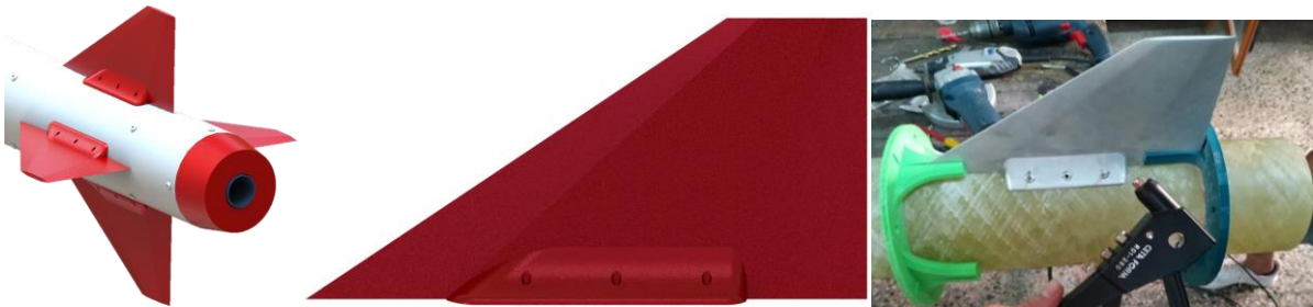
Şekil: 1,5 Adana WOF Roketine Ait Kanatçık Görünümleri (Solda ve Ortada), Kanatçıkların Üretilmiş ve Montajlanmış Hâli (Sağda)
