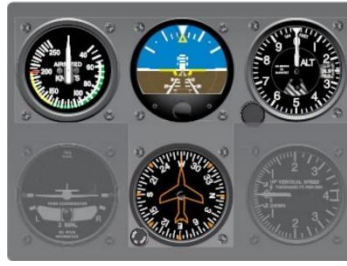
Şekil 8. Temel T Yerleşiminde Uçuş Göstergeleri
