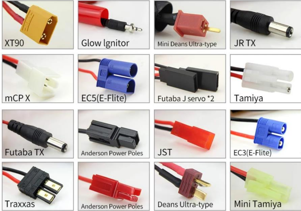
Şekil 7. Batarya Konnektör Örnekleri
