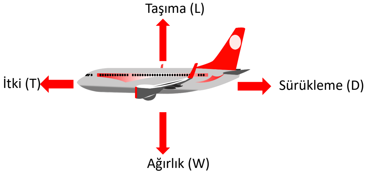
Şekil 5. Uçağa Etki Eden Temel Kuvvetler
