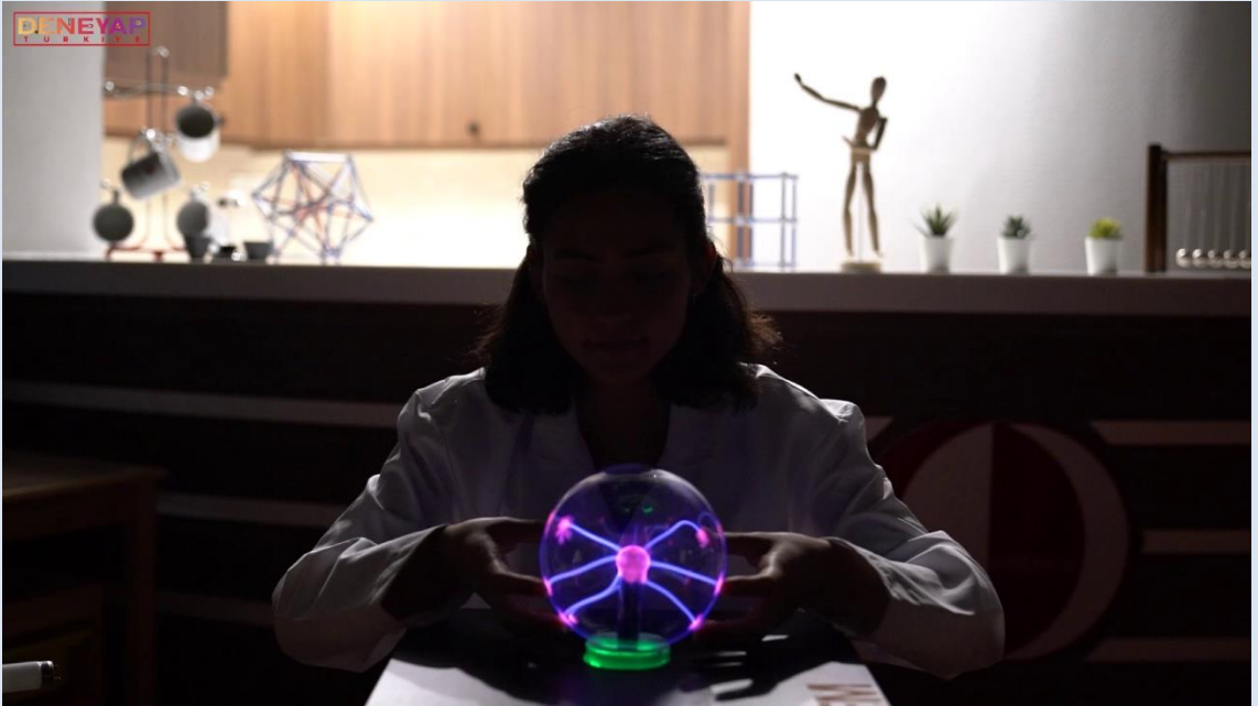
Plazma küresine çıplak el ile dokunulduğunda yönleri değişen enerji yayları
