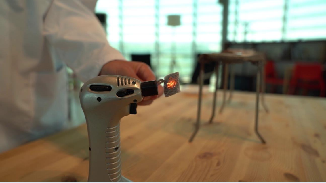
Aerojel kumaş parçasının pürlüz yardımcıyla ısıtılması
