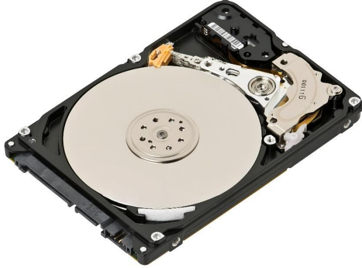
Bilgisayarlarda kullanılan bir sabit disk sürücünün (HDD) iç yapısı
