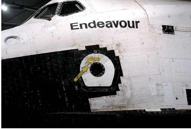
NASA tarafından kullanılan bir uzay mekiğinin ön ve alt kısmında görülen siyah seramik karolar https://commons.wikimedia.org/wiki/File:Space_Shuttle_Endeavour_Hatch - Flickr - FastLizard4.jpg
