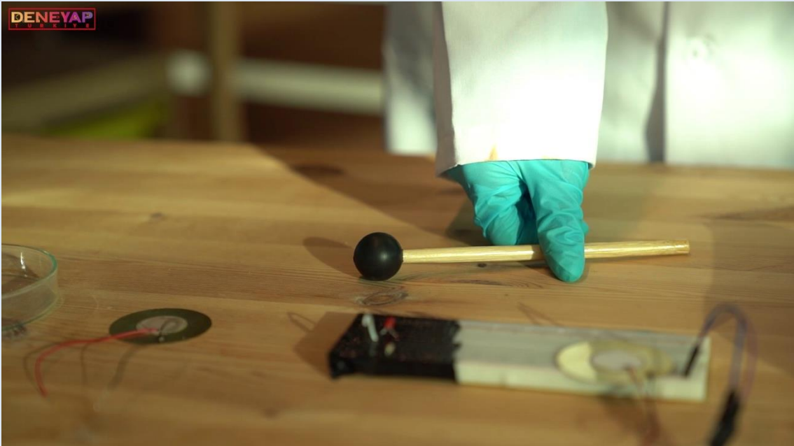
Piezoelektrik malzemeye mekanik basınç oluşturmak için kullanılan tokmak
