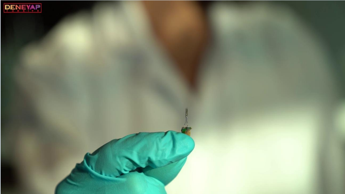
Kuvars saat ierisinde bulunan piezoelektrik malzeme
