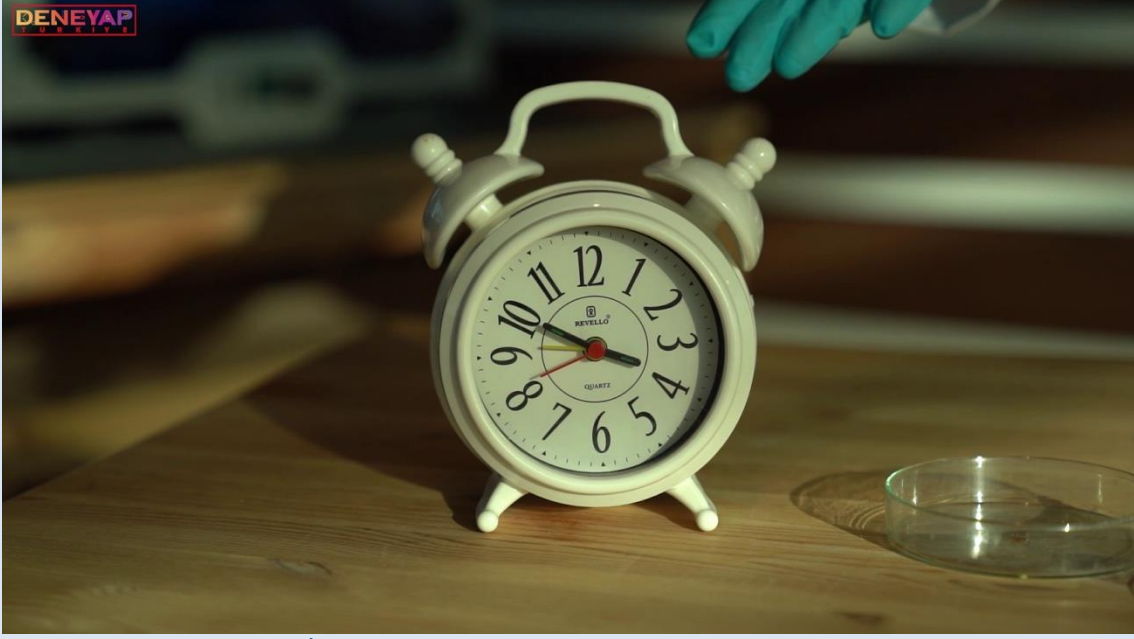
İerisinde Piezoelektrik malzeme bulunan Kuvars saat
