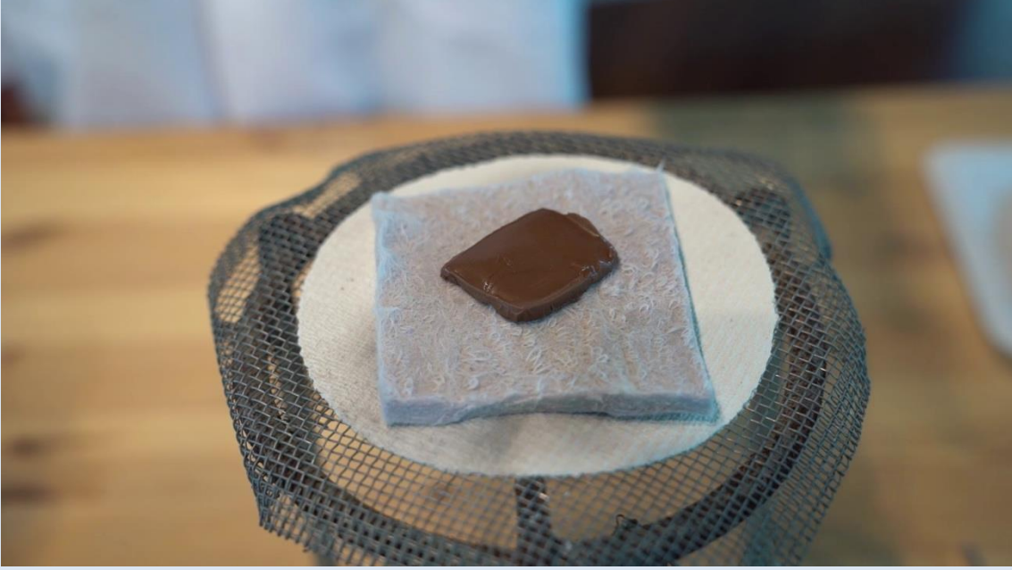
Aerojel kumaş parçasının ısıtılması sonuca hızlıca erimedığı gözlemlenen çikolata parçası
