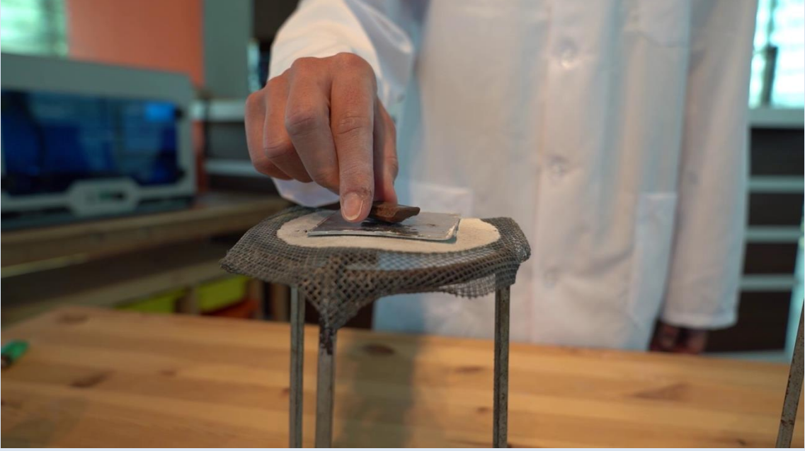
Çikolata parçasının alüminyum plaka üzerine yerleştirilmesi
