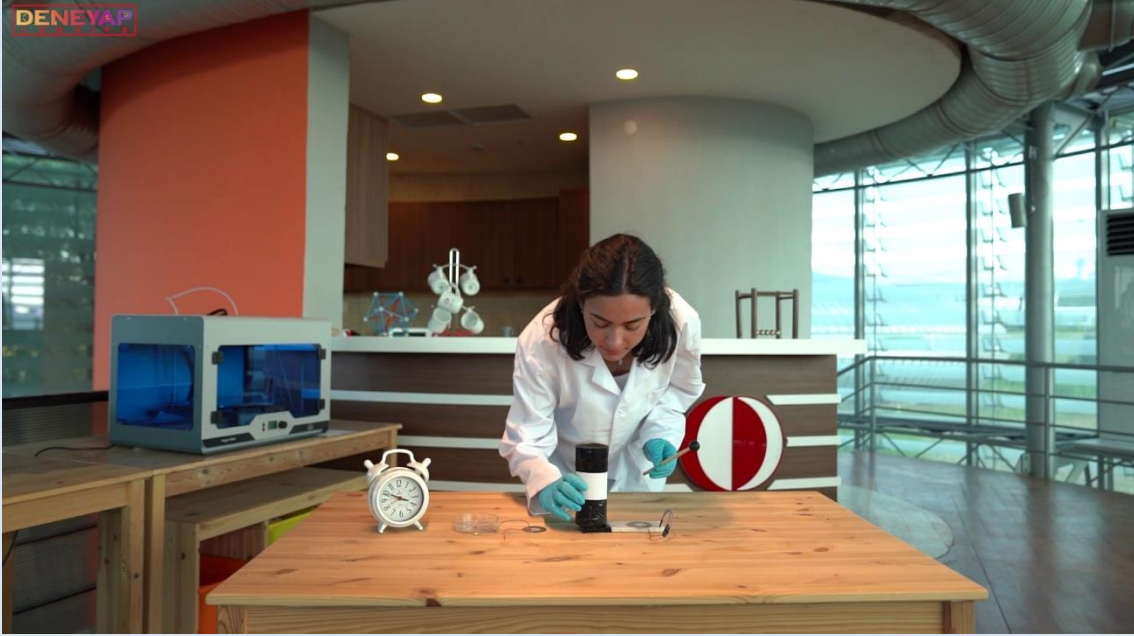
Rulo haline getirilmiř siyah fon kağıdı kullanılarak LED'in gözlemlenmesi
