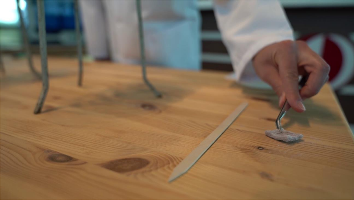
Cımbız yardımıyla tutulan aerojel kumaş parçası
