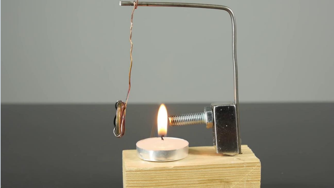
Mum tarafından ısıtılan nikel parçanın mıknatıstan uzaklaşması
