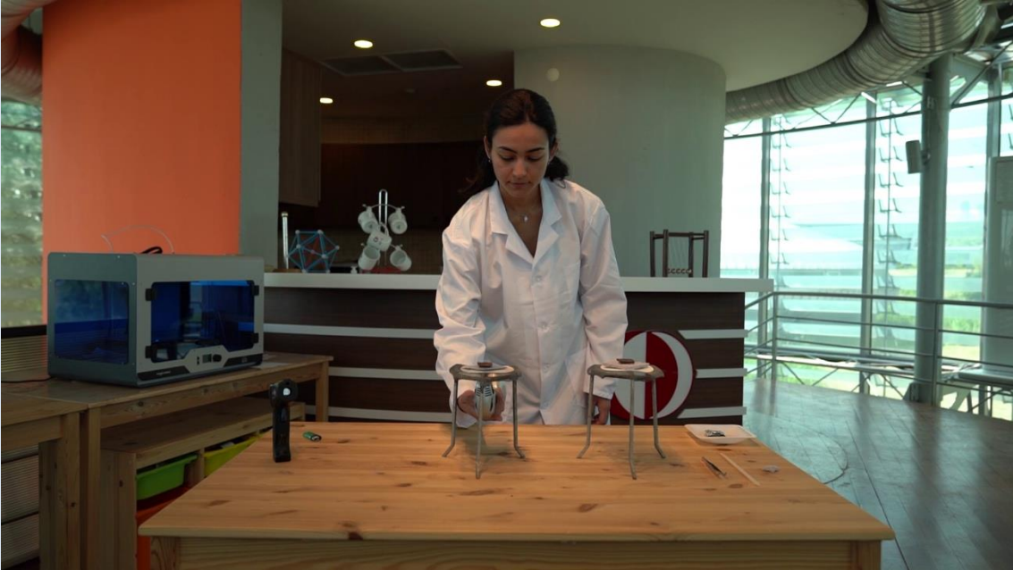
Yanan pürmüz yardımıyla alüminyum plakanın ısıtılması
