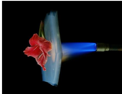
Oksijen kaynağı ile doğrudan verilen ateşi yalıtıp üzerindeki çiçeği ateşten koruyan bir aerojel https://commons.m.wikimedia.org/wiki/File:Aerogelflower_filtered.jpg#mw-jump-to-license
