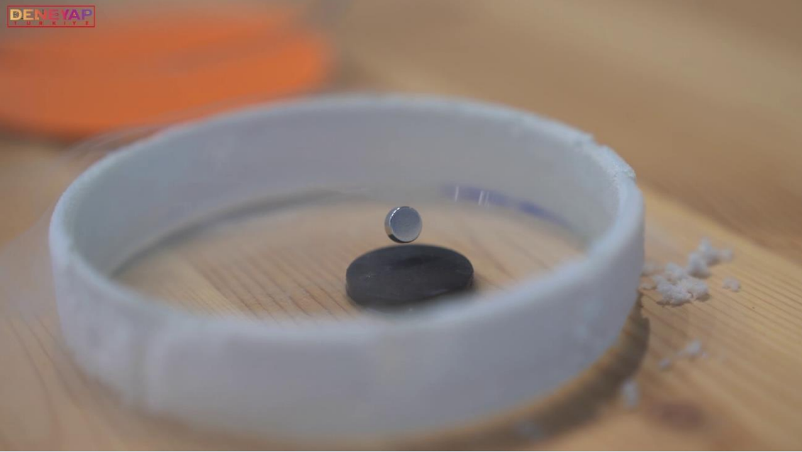
Süperiletken malzeme kritik sıcaklık altına indiğinde üzerindeki mıknatısın havada asılı kalması
