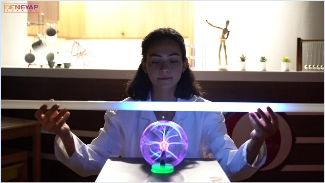
Uzun bir floresan lambanın plazma küresine yaklaştırıldığında yalnızca iki el ile kısıtlanan aralığın ısıldadığının görülmesi
