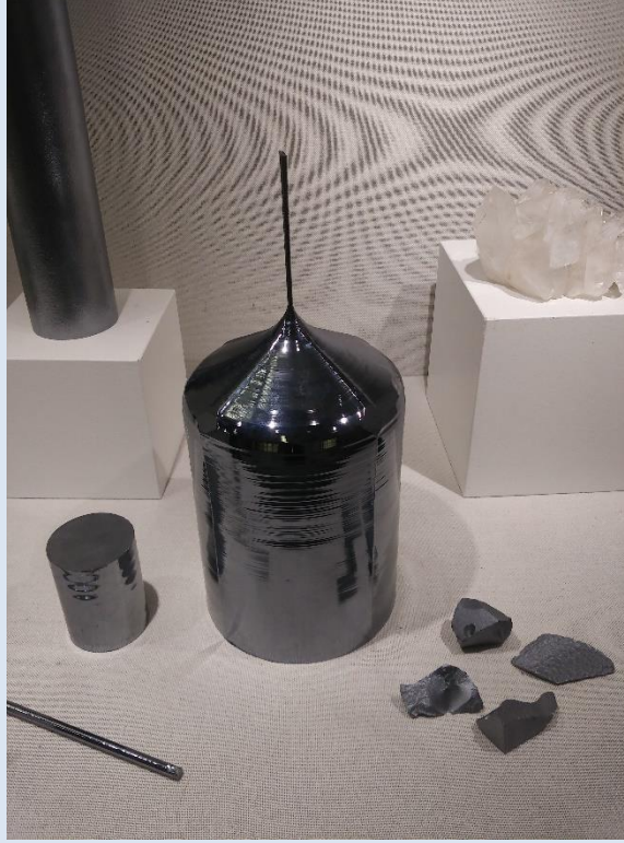
Czochralski Yöntemiyle Büyütülen Silisyum Kristali Külçe.
