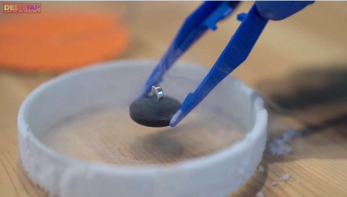
Havada asılı kalan mıknatısın süperiletken malzeme hareket ettirildiği durumda dahi pozisyonunu koruması
