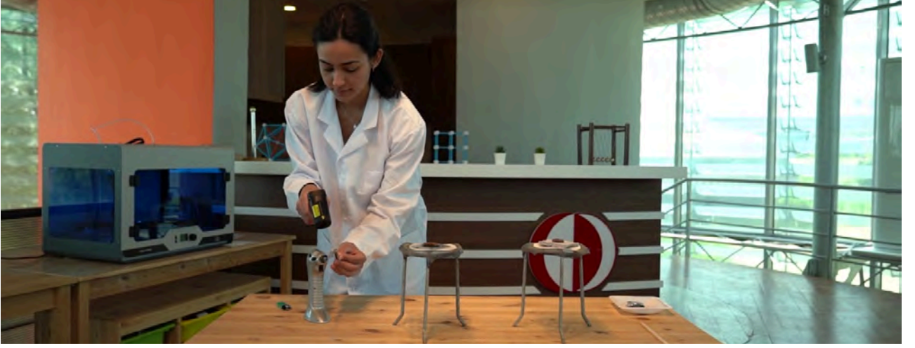
Isıtılan aerojel kumaş parçasının sıcaklığının kızılötesi temassız termometre ile ölçülmesi
