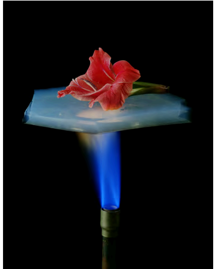
Oksijen kaynağı ile doğrudan verilen ateşi yalıtıp üzerindeki çiçeği ateşten koruyan bir aerojel.
