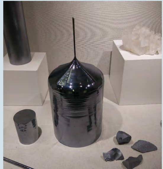
Czochralski Yöntemiyle Büyütülen Silisyum Kristali Külçe.
