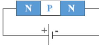
Resim 4.6: NPN Transistör Devre Bağlantısı
