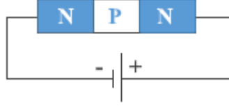
Resim 4.5: NPN Transistör Devre Bağlantısı
